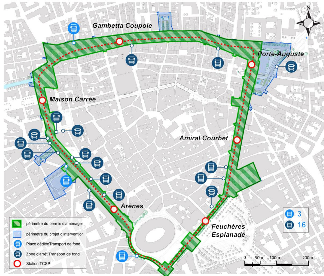
Figure 7 Schéma d'implantation des transports de fond
