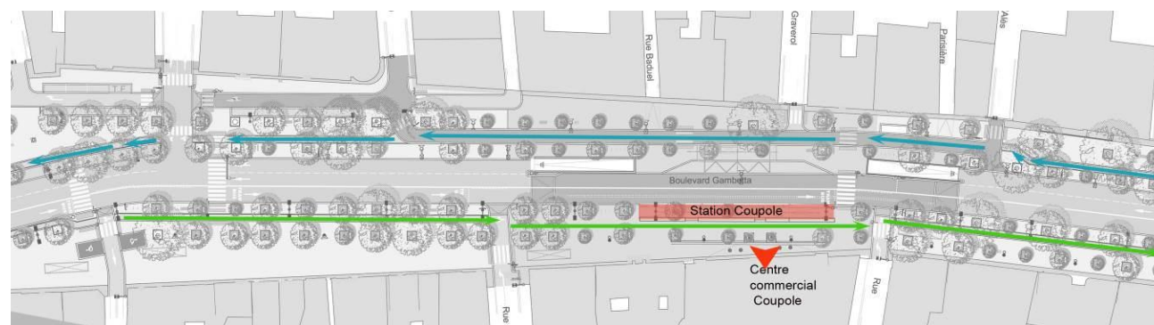
Figure 45- Gestion des cheminements cyclables au droit des trémies du Parking de la coupole
