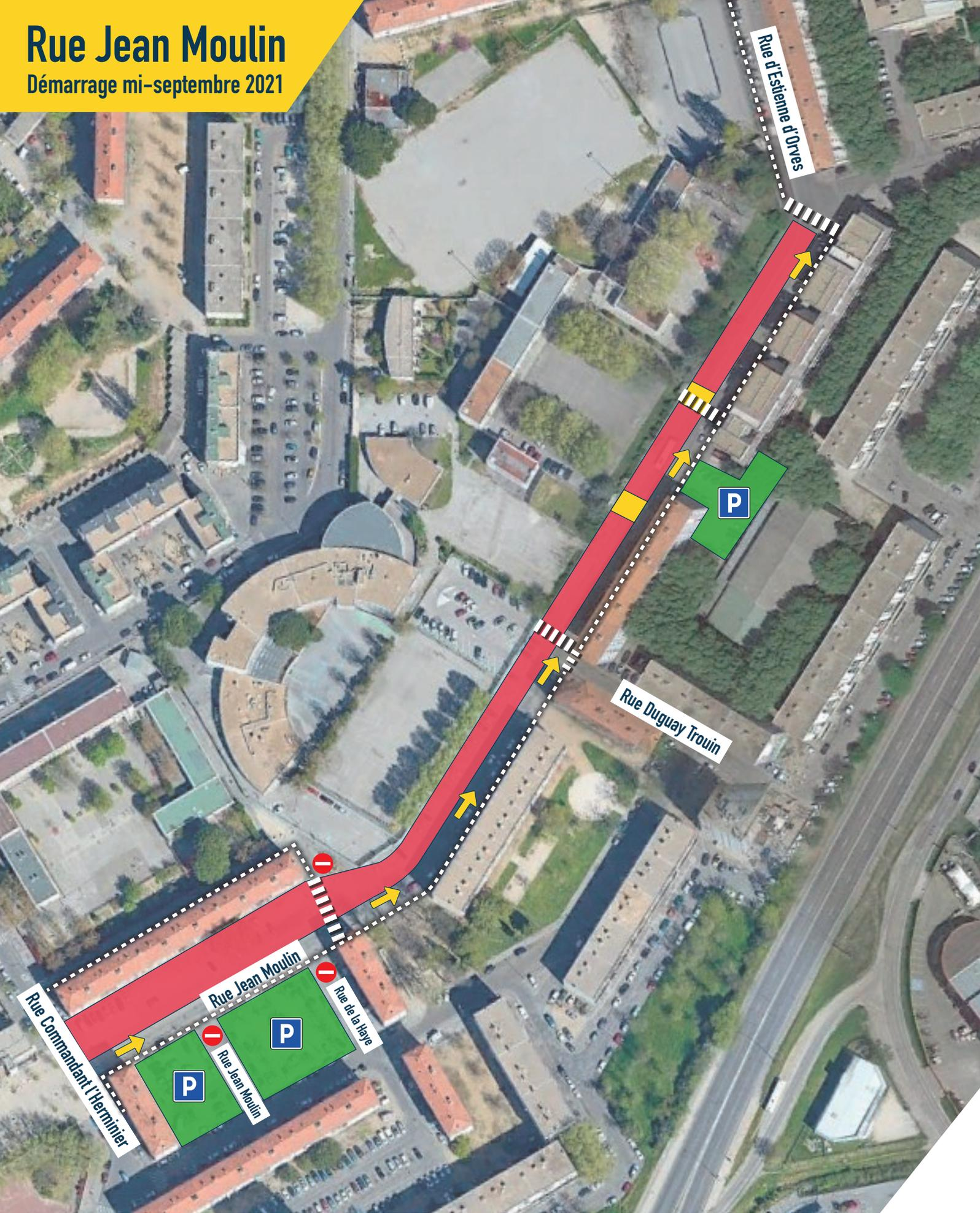
Les travaux : Circulation à sens unique / Réalisation du trottoir nord et de la voie Tram'bus au nord.
